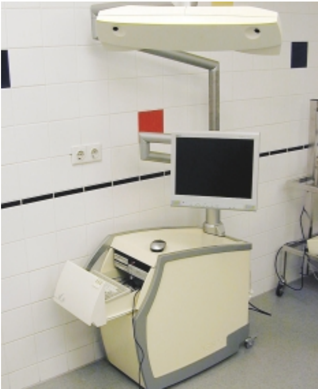
Abb. 3: Das Gerät des IGI, bestehend aus Corpus mit 2 PC, Bildschirm, Halterung mit 2 Positionskameras, Anschlüsse für Handstück- und Schienensensoren, Fussschalter.
